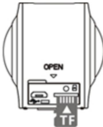
**Note:** Ninguna tarjeta de memoria integrada viene en la cámara. Asegúrese de insertar la tarjeta de memoria antes de cada uso.
