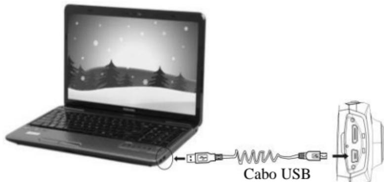
Conecte a câmera de vídeo ao computador para carregar. O indicador luminoso de carga será desligado após o carregamento. Em geral, o carregamento leva 2-4 horas.
