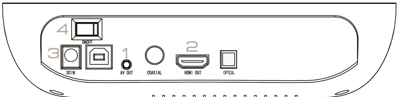
1. Conecte o D-522 à televisão com o cabo AV (dependendo da configuração).
