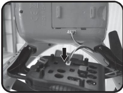
1. Schließen Sie das Kamerakabel mit dem speziellen Stecker an die Drohne an.
