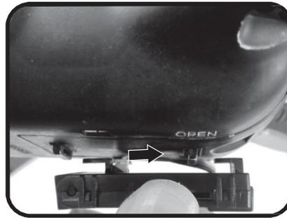
2. Befestigen Sie die Kamera in der Drohne, indem Sie die Schlaufen in die Vertiefungen drücken.
