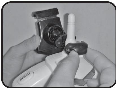
3. Installieren Sie den Bügel an der Radioantenne.
