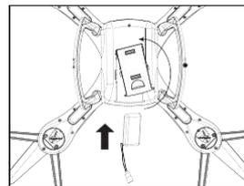
3. Öffnen Sie das Batteriefach und legen Sie die Batterie ein. Verbinden Sie die Batterie mit der
