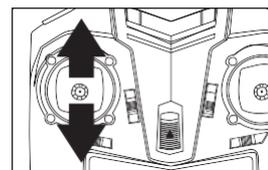
6. Drücken Sie den linken Joystick nach oben und unten; es ertönt ein „Piepton“, der darauf hinweist, dass die Fernbedienung mit der Drohne verbunden ist (LED leuchtet stetig). Die
