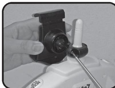
4. Vissez le support smartphone solidement autour de l'antenne de la radiocommande.
