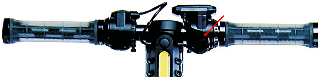
Appuyez sur le frein moteur pour freiner ou appuyez sur la roue arrière pour freiner manuellement.
